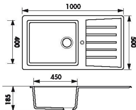
**Profondeur de cuve : 185 mm**
